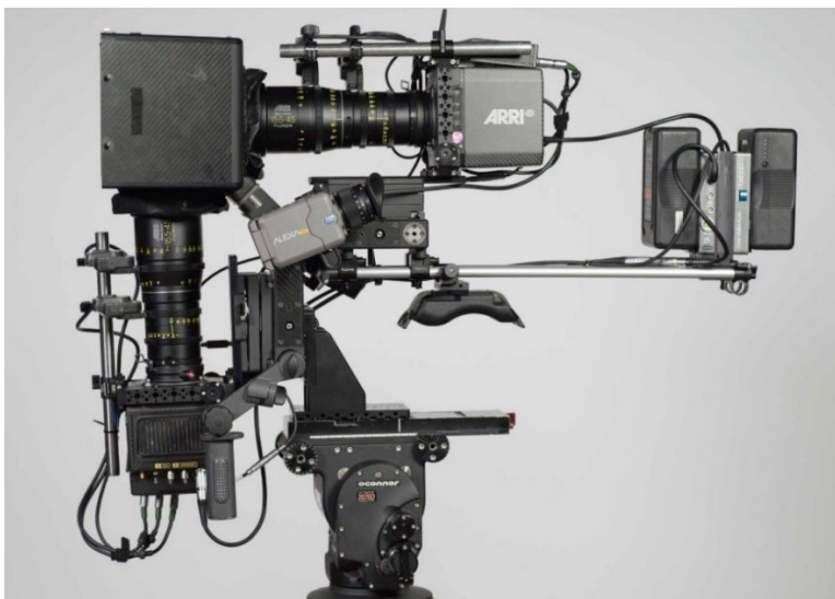
Rig stereoskopowy (źródło: materiały ze strony firmy rentalowej: https://3drig.eu/ ; dostęp: 30.08.2023)
